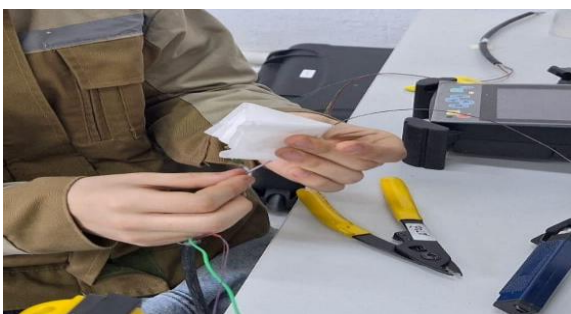
Кабелді тазалау барысы: сыртқы қабатын ажырату, сүрту
